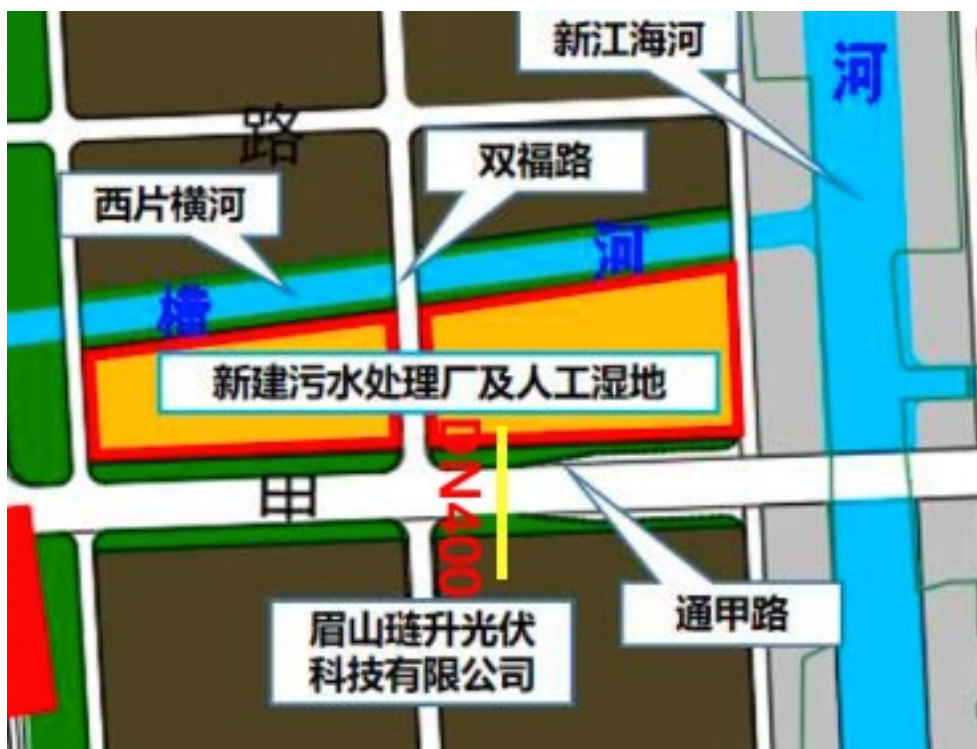
图 3.3.1-2 江苏璜升科技有限公司管线方案图
